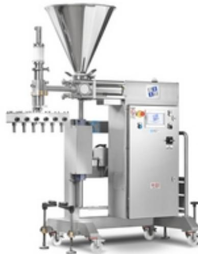
La dosatrice volumetrica elettronica (DVE) dispone di un dispositivo di pompaggio a siringa azionato da motore brushless e controllato da software su touch screen. Può lavorare in linea sul trasportatore o indipendente a banco.
